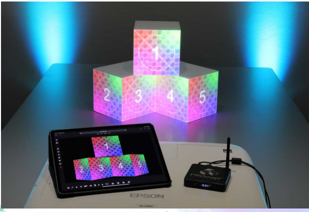
Freies Projection Mapping per Tablet auf Styropormodell.
